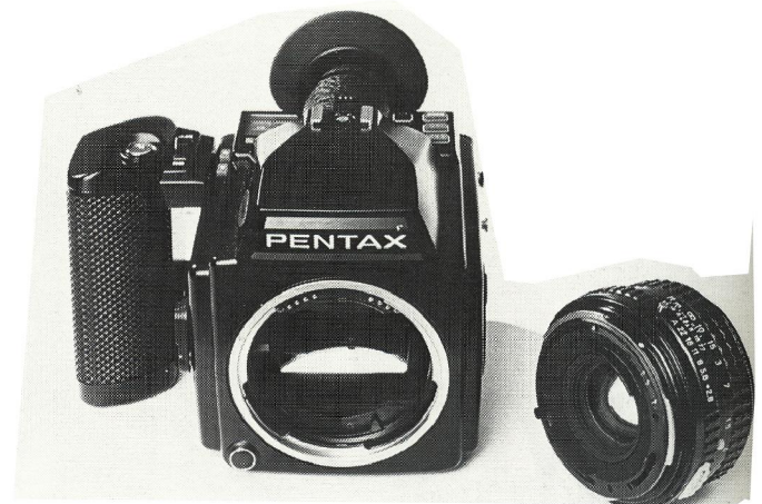
Objektivets blændeindstillinger overføres til kamerahuset ved hjælp af elektriske kontakter - som på Pentax A kameraerne til 24x36 formatet.
